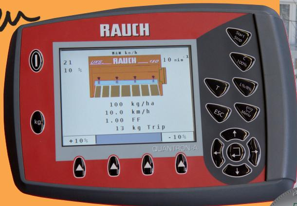
**QUANTRON-A: elektronische, geschwindigkeitsabhängige Dosierung (Option)**
