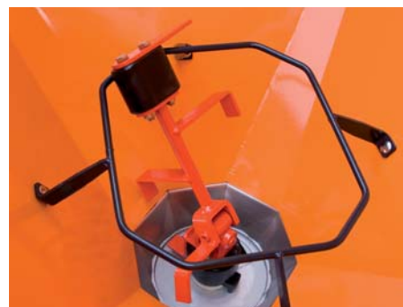
Mieszadło obraca się w pierścieniu chroniącym zbiornik.
