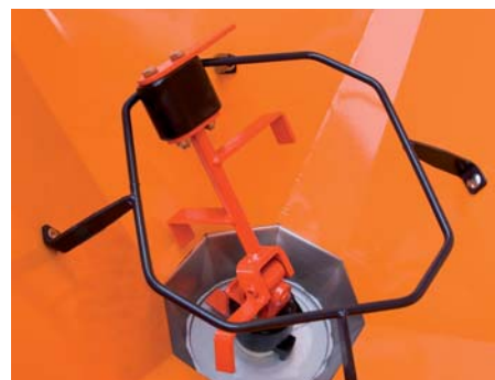
Omrøreren roterer i en påløbsring og skåner således beholderen.
