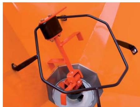
L'agitateur pivote dans l'anneau d'usure sans abîmer la trémie.
