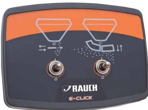
E-Click: Sähkökäyttöinen kauko-ohjaus annostusluistille ja levityisleveyden rajoitukselle
