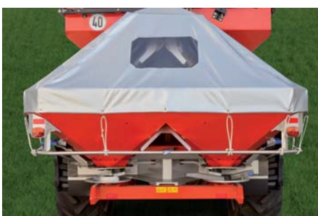
Plachta z volitelného příslušenství chrání před nečistotami a vlhkostí.
