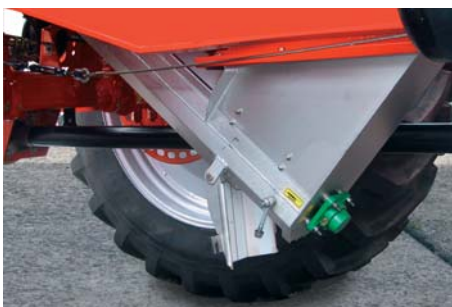
Zvenku umístěný šnekový dopravník kontrolovaný snímači umožňuje snadný přístup, i když je zásobník naplněn.
