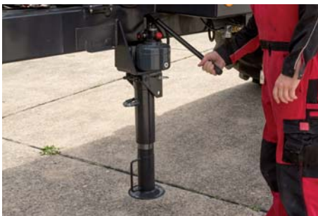
Hydraulická vzpěrná noha usnadňuje připojení a odpojení.
