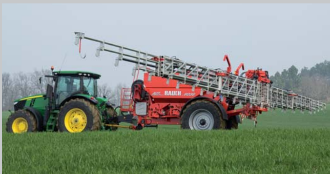
Der größte RAUCH-Düngerstreuer: Pneumatik-Düngerstreuer AGT 6036 mit 36 m Ausleger verteilt die Düngerkörner exakt auf dem Feld, damit jede Pflanze wichtige Nährstoffe erhält.
