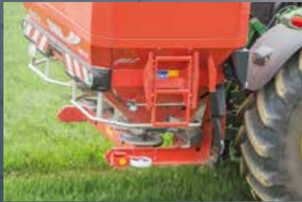
AXIS H – Wysiew krańcowy z prawej i z lewej strony poprzez regulację prędkości obrotowej tarczy i punktu spadania nawozu
