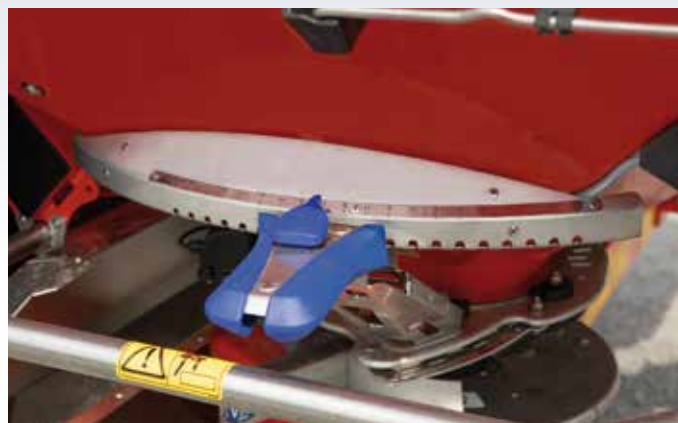
Manualna regulacja punktu spadania nawozu na tarczę
