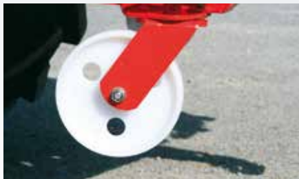
Rolki podporowe z systemem szybkozłączy
