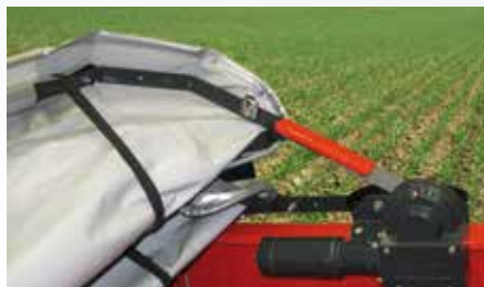
Plandeka zbiornika ze zdalnym elektrycznym sterowaniem
