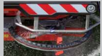
AXMAT duo: Radarstøttet, automatisk kontroll og regulering av spredebilde (se side 12)
