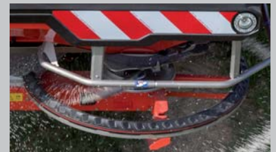
AXMAT duo: Radar automatisk kontroll av spridningsbild (se sida 12)
