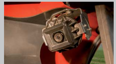
Kamera med sikt bakåt: Ha koll bakom maskinen
