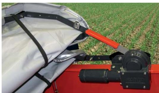
Lona de cubierta controlable a distancia eléctricamente
