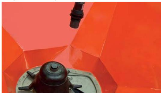
Sensores de indicación de vacío
