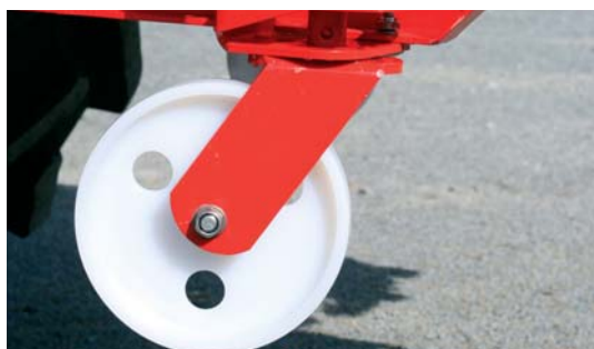
Ролики останова с системой быстрого соединения
