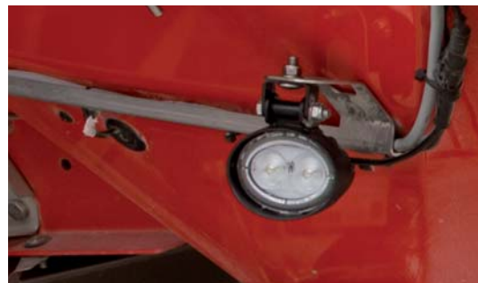
Высококачественные светодиодные фары SpreadLight
