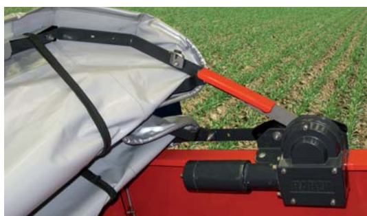
Защитный тент с электрическим дистанционным управлением
