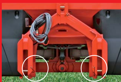
Méréstechnika két mérlegcellával
