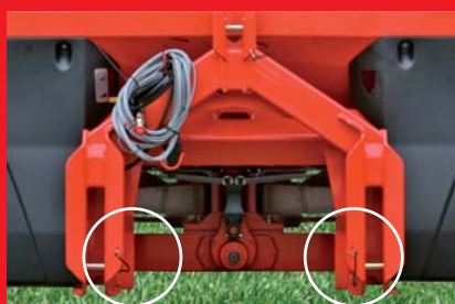
Рама системы взвешивания с двумя датчиками массы
