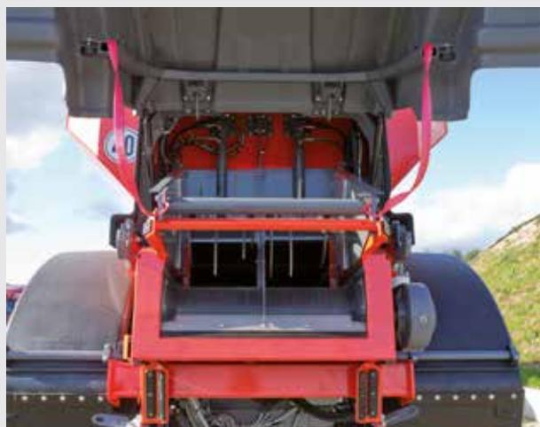
**Wartungsklappe** mit Gasdruckfeder
