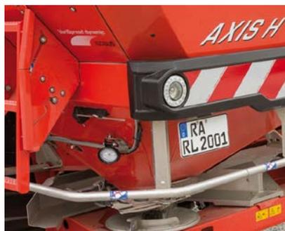
Der Fahrer hat mit SpreadLight die gesamte Expansion des Streufächers immer im Blick. Mögliche Fehleinstellungen oder Verstopfungen an den Dosierschiebern werden sofort erkannt. Darüber hinaus kann der Fahrer bei Dunkelheit schneller auf schwer erkennbare Hindernisse oder Gefahrenstellen in äußeren Streubereich gerade bei großen Arbeitsbreiten reagieren.
