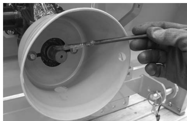
Figure 6.4 : Graisser l'axe du carter
