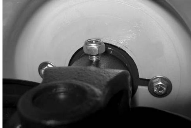
Billede 6.6: Spænd sekskantbolten
