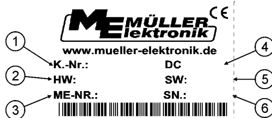
Placa de fabricație de pe partea din spate a terminalului
