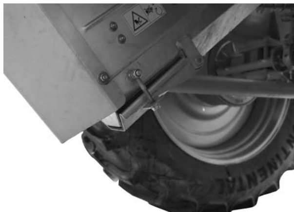
Slika 7.3: Poklopac za pražnjenje ispod rezervoara
