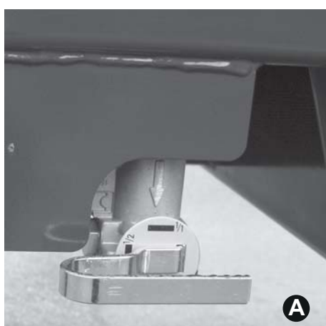
Slika 6.21: Podešavanje regulatora sile kočenja
