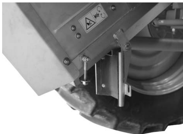
Slika 7.4: Otvoren poklopac za pražnjenje
