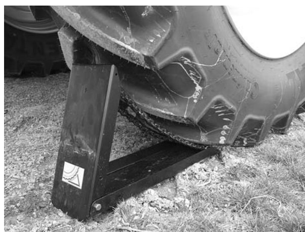
Obrázek 7.8: Umístění klínů pod kola
