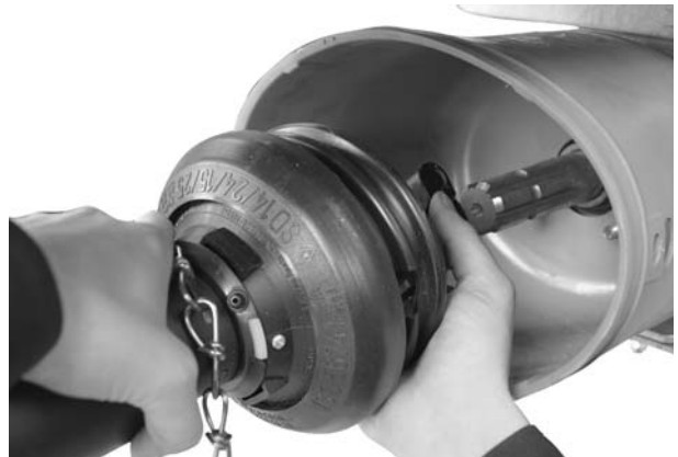
Obrázek 6.1: Nasadte kloubový hřídel na čep převodovky.
