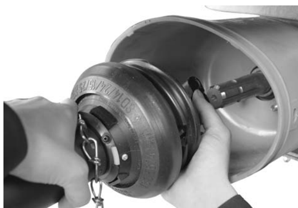
Rysunek 6.1: Wsuwanie wału przegubowego na czop przekładni
