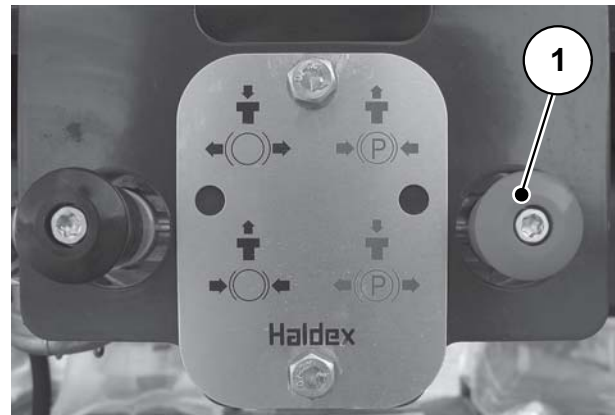
Rysunek 7.6: Zaciągnąć hamulec postojowy
