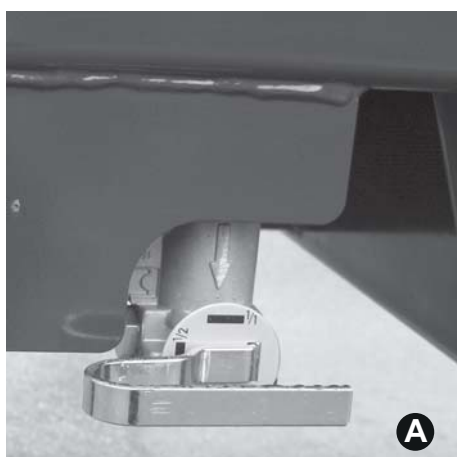
Rysunek 6.21: Ustawianie regulatora siły hamowania
