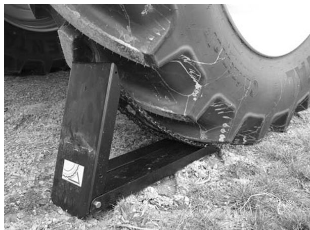
Rysunek 7.8: Ustawianie podkładki klinowej
