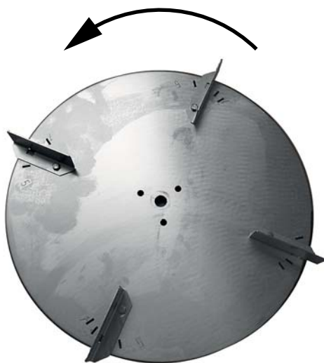
Obrázek 7.3: Směr otáčení rozmetacího disku
