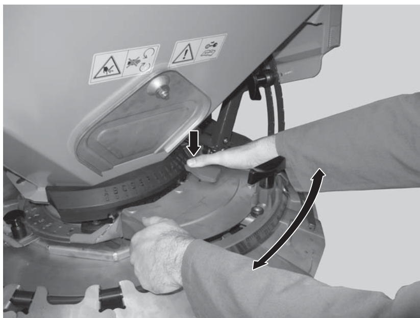
7.6 ábra: Feladási pont beállító központja
