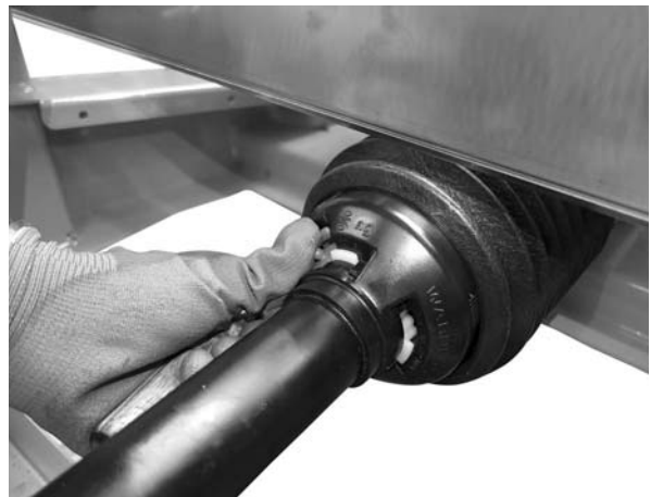
6.5 ábra: A kardántengely-védelem rögzítése
