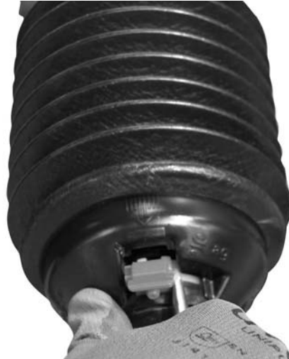
Obrázok 6.1: Otvorenie krytu kĺbového hriadeľa
