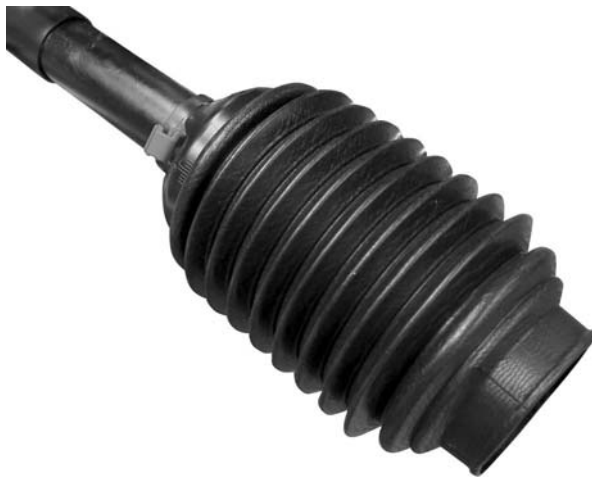
Obrázok 3.4: Ochranný kryt kĺbového hriadeľa
