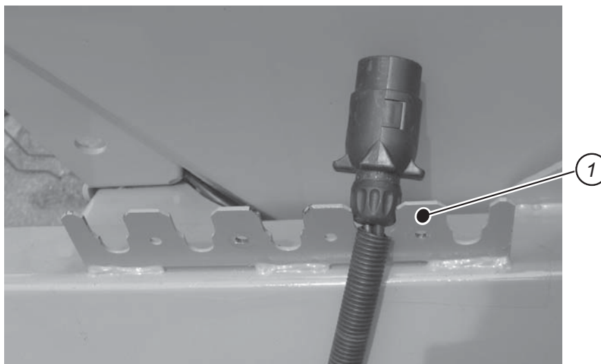
Obrázek 6.6: Uložení kabelů a hydraulických hadic
