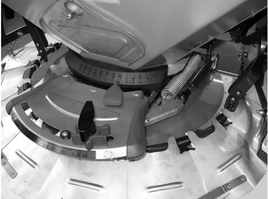
Imagen 6.10: Corredera de dosificación abierta, cilindro hidráulico en el tope del extremo
