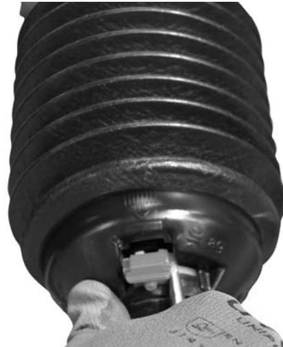
**Figura 6.1:** Aprire la protezione dell'albero cardanico
