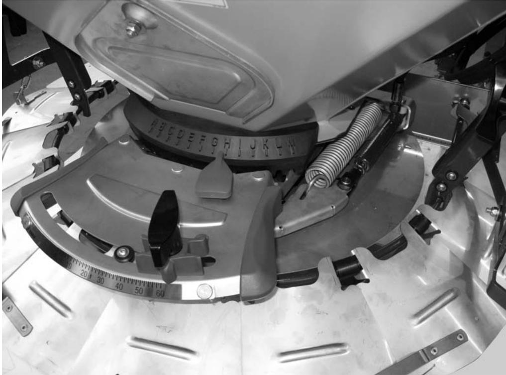
**Figura 6.10:** Dosatore aperto, cilindro idraulico sulla battuta di finecorsa
