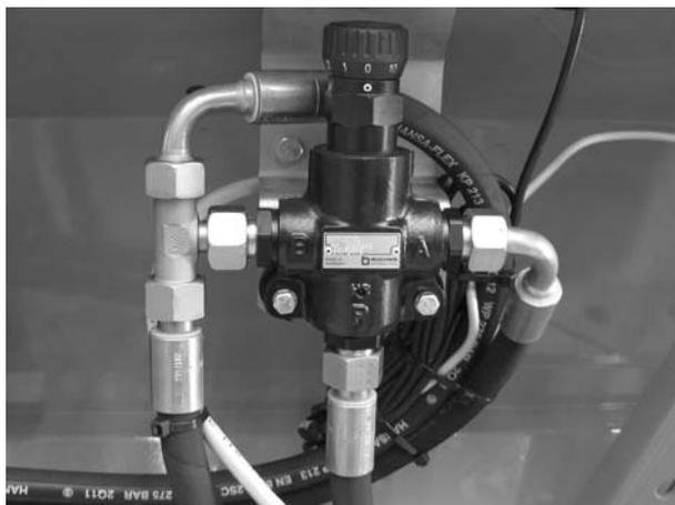
**Figura 6.8:** Valvola di regolazione della portata
