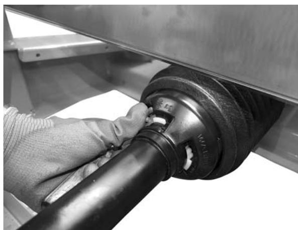
**Figura 6.5:** Fissare la protezione dell'albero cardanico
