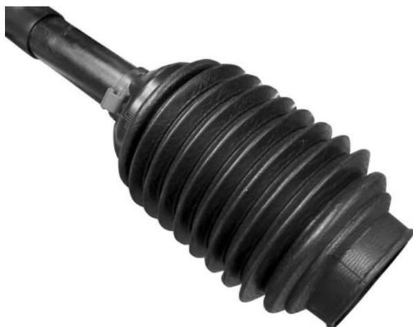
**Figura 3.4:** Protezione dell'albero cardanico
