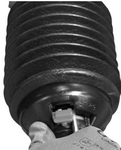
Afb. 6.1: Beveiliging cardanas openen
