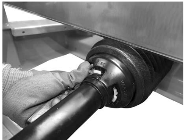
Afb. 6.5: Beveiliging cardanas vastzetten.
