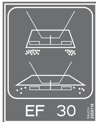
Afb. 6.9: Markering van de besturingsunits voor de strooibreedtebeperking
