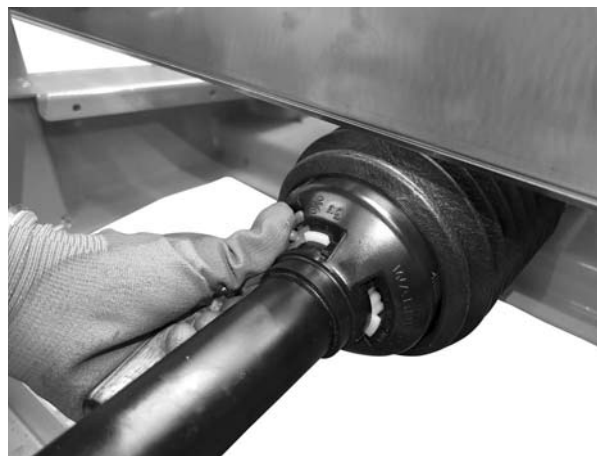
Billede 6.5: Sikring af kardanakselbeskyttelsen
