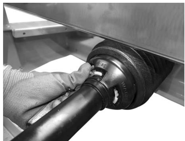
Figure 6.5 : Bloquer la protection de la transmission
