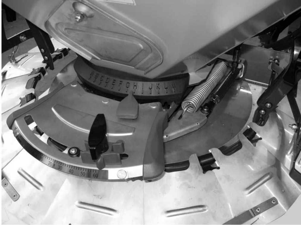
Figure 6.10 : Vanne de dosage ouverte, vérin hydraulique sur la butée de fin de course
