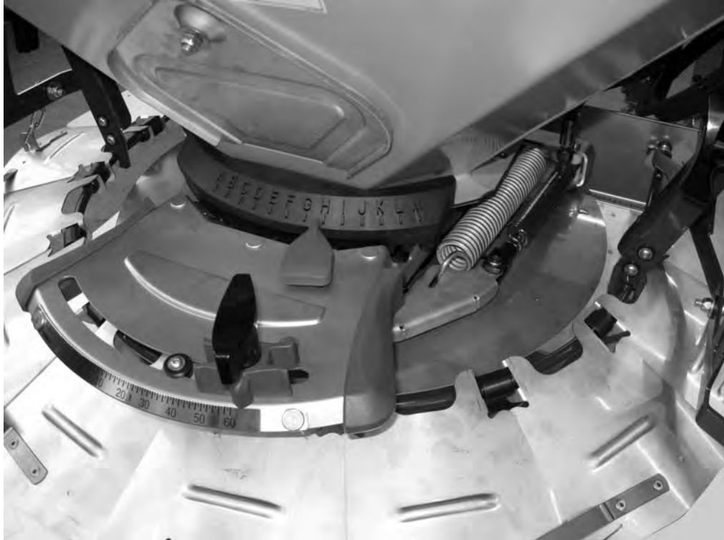
Bild 6.10: Dosierschieber geöffnet, Hydraulikzylinder auf Endanschlag
