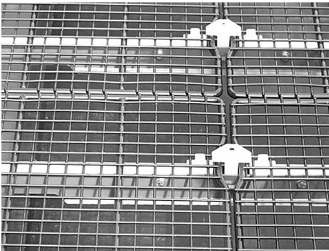
Figure 6.22 : Sécuriser le tamis de remplissage dans la trémie
