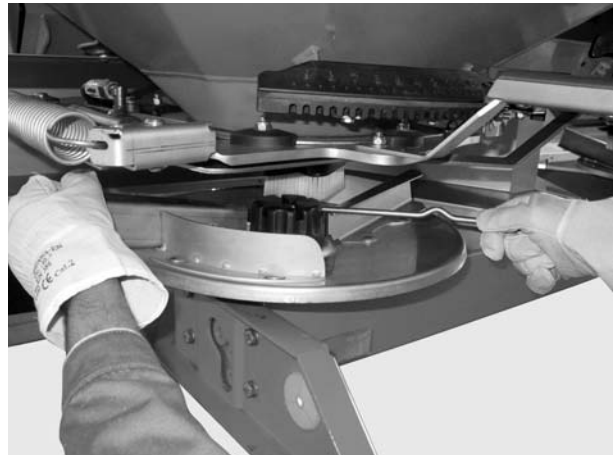
Figure 7.11 : Dévisser l'écrou borgne
