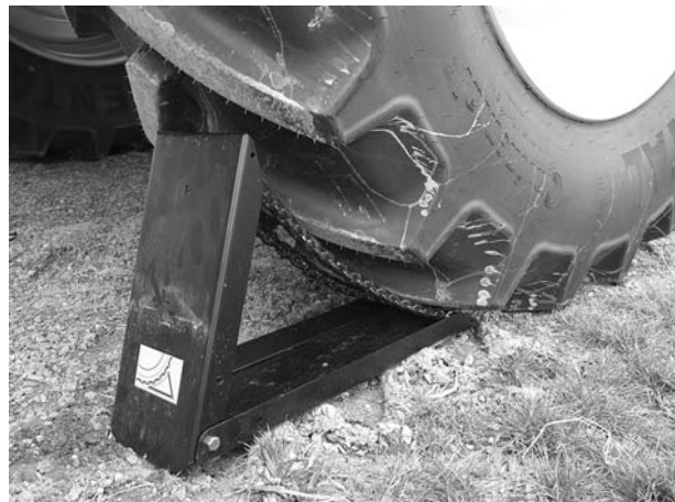
Imagen 7.25: Colocación de la cuña
