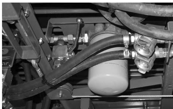
Imagen 9.28: Filtro de aceite de la suspensión de la barra
