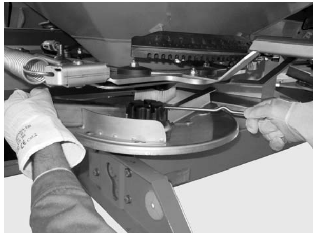
7.11 pav.: Gaubiamosios veržlės atlaisvinimas
