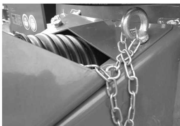
6.5 pav.: Pritvirtinkite laikančiąją grandinę
