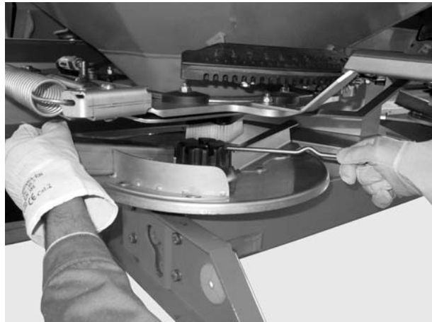
Billede 7.11: Løsning af kalotmøtrikken
