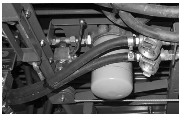
Billede 9.28: Oliefilter vognstangsaffjedring
