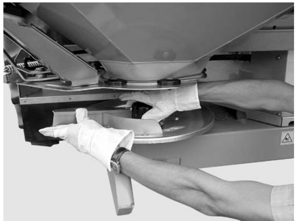
Billede 7.12: Udskruning af kalotmøtrikken
