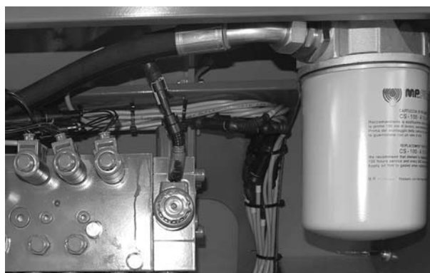
Obrázek 9.27: Olejový filtr u řídicího bloku.
