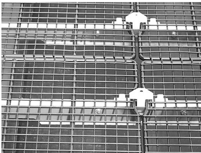
Obrázek 6.22: Zajištění plnicího síta v zásobníku
