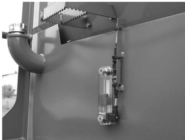
Imagine 9.25: Poziție afișare stare de plin ulei
