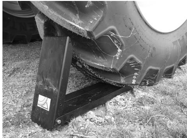
Imagine 7.25: Poziționare pană de blocare
