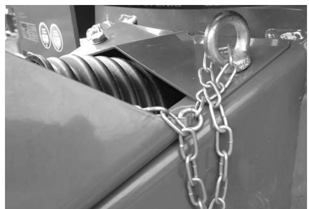
Imagine 6.5: Fixați lanțul de susținere
