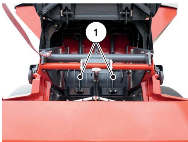
Рисунок 6.34: Заслонки устройства предварительного дозирования в закрытом положении
