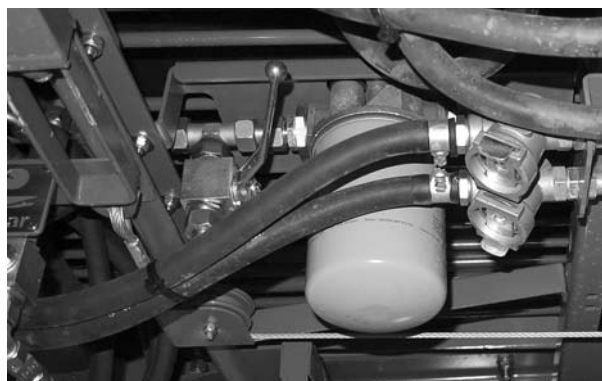
Rysunek 9.28: Filtr oleju amortyzacji dyszla
