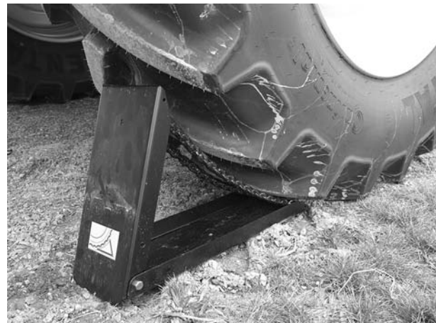
Rysunek 7.25: Ustawianie podkładki klinowej
