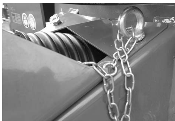
Rysunek 6.5: Mocowanie łańcucha przegubowego
