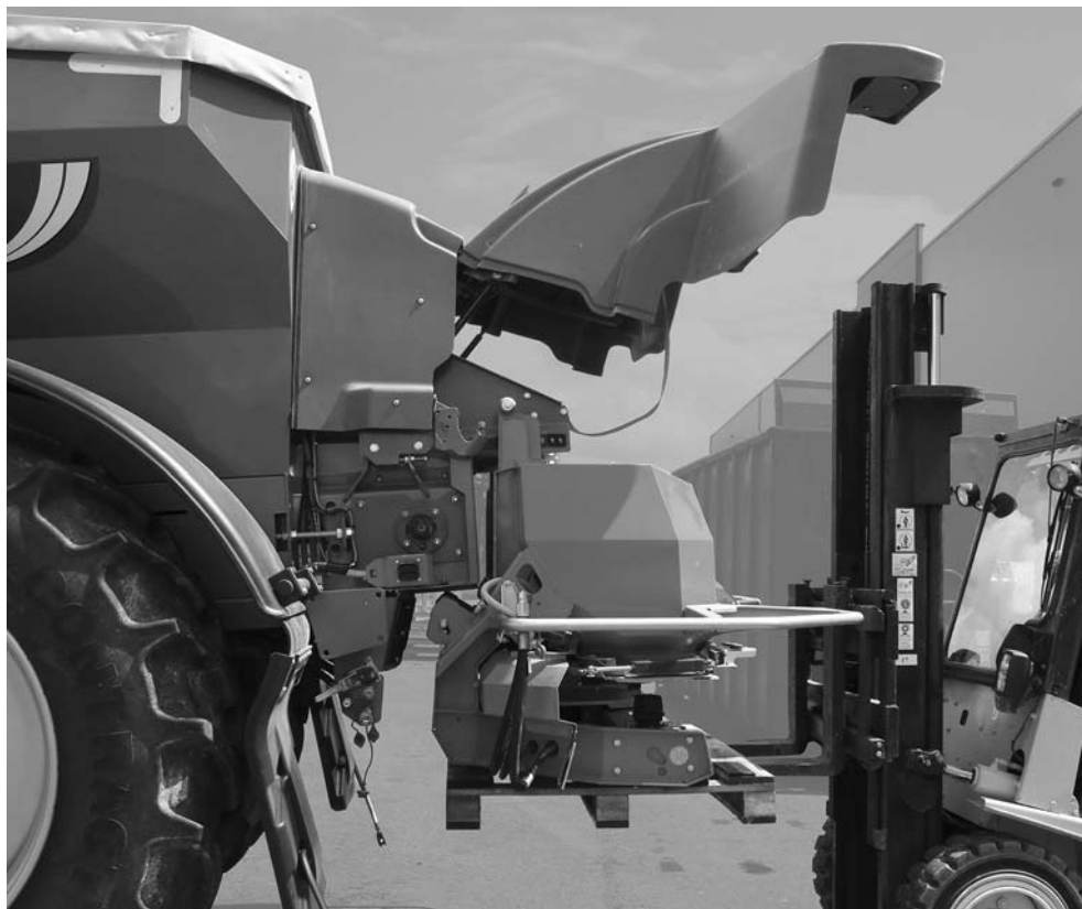
Rysunek 6.24: Podjazd wózkiem widłowym
