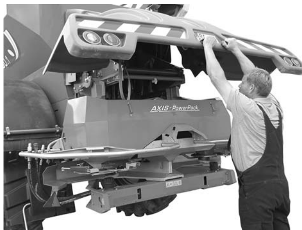
Rysunek 7.3: Chwytywanie uchwytów osłony opuszczanej
