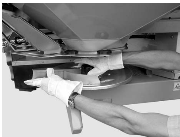
Rysunek 7.12: Odkręcanie nakrętki kołpakowej
