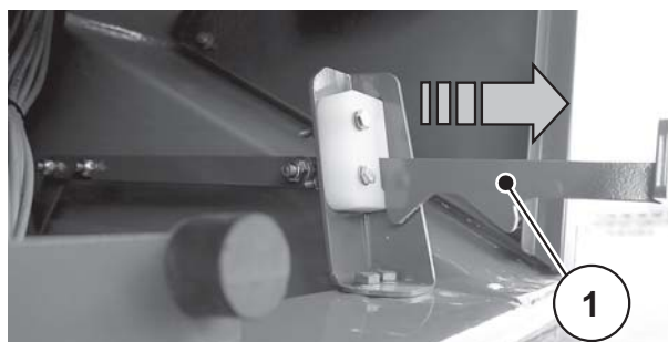
Rysunek 9.5: Dźwignia kłapy czyszczącej
