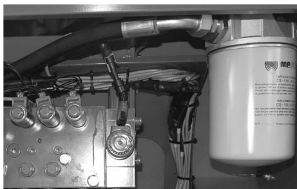
Rysunek 9.27: Blok sterujący filtra oleju
