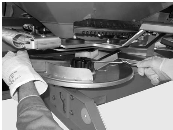
Rysunek 7.11: Odkręcanie nakrętki kołpakowej
