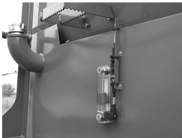
Rysunek 9.25: Położenie wskaźnika poziomu napełnienia
