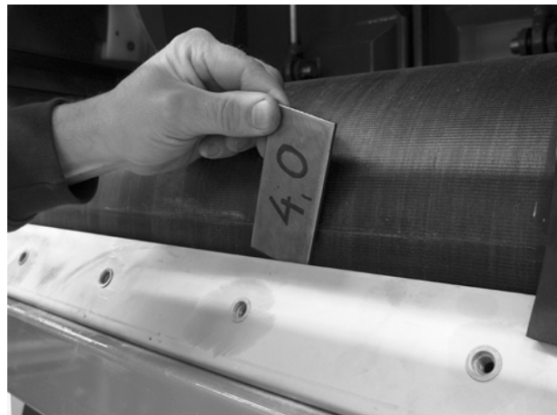
Rysunek 9.21: Sprawdzanie odstępu
