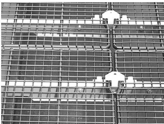
Rysunek 6.22: Zabezpieczenie sita zasypowego w zbiorniku
