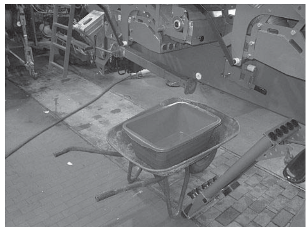
Imagine 7.6: Recipientul de captare al îngrășămintelor sub dispozitivul de dozare
