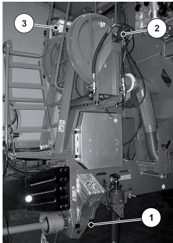
Imagine 10.16: Verificarea pompei cu pistoane axiale, a motorului cu pistoane axiale și a radiatorului de ulei
