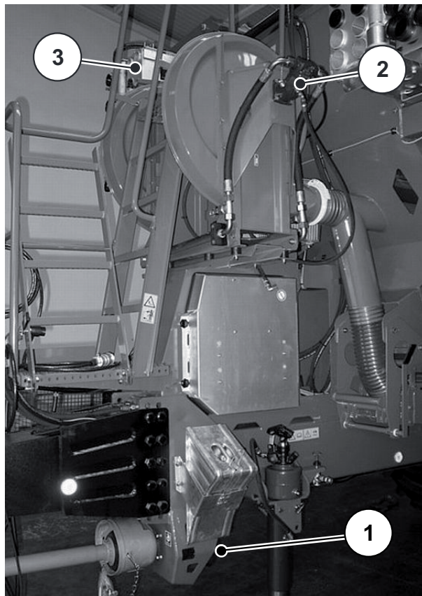
Фиг. 10.16: Проверка на аксиално-буталната помпа, аксиално-буталния двигател и маслоохладителя
