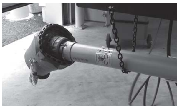
Rysunek 6.5: Mocowanie wału przegubowego
