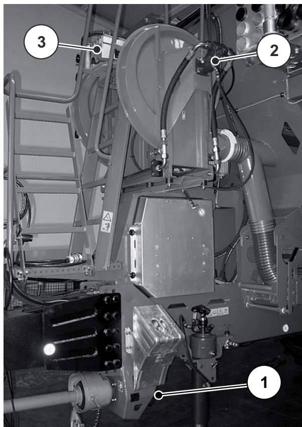
Rysunek 10.16: Sprawdzenie wielotłokowej pompy osiowej, silnika wielotłokowego i chłodnicy oleju
