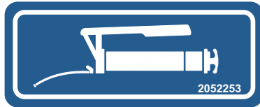
10.38 ábra: Kenőhely figyelmeztetőtábla
