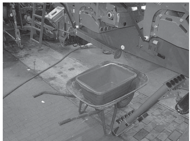
7.6 ábra: Trágyafelfogó tartály az adagolóberendezés alatt
