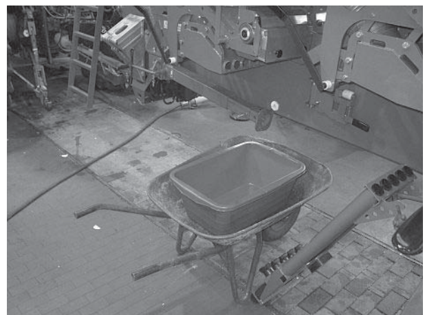
Bild 7.6: Düngemittelauffangbehälter unter der Dosiereinrichtung
